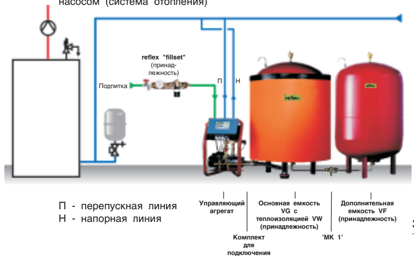
Пример: установка reflex "variomat" с одним насосом (система отопления)
